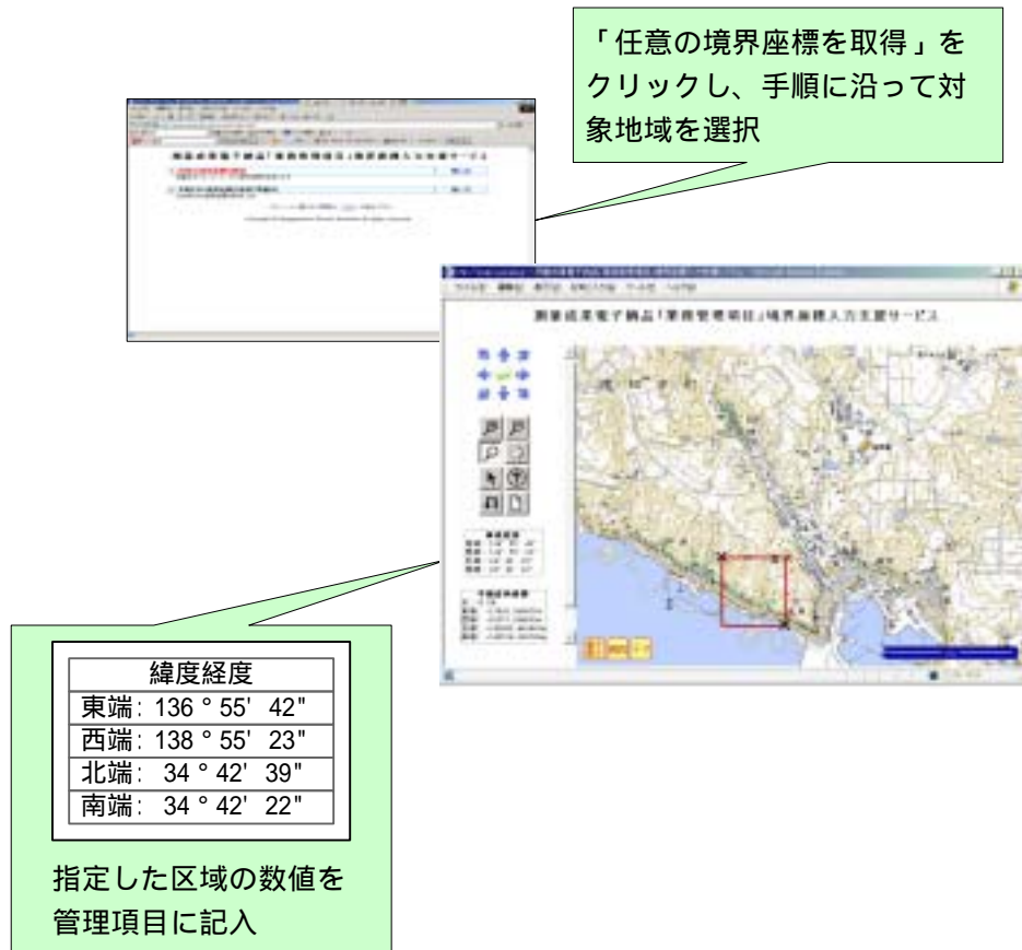
図 6-18 測量成果電子納品「業務管理項目」境界座標入力支援サービス
